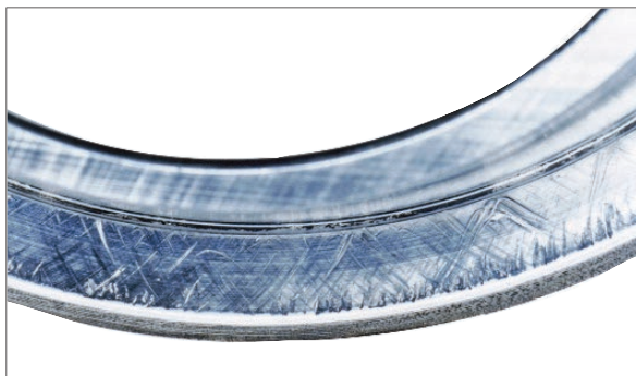
그림 34 자동조심롤러베어링 턱의 뜯김
