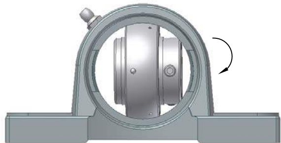
① [그림 9.9] 회전방지 고정편이 유니트의 뒷면으로 오도록 회전시킨다
