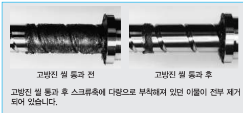
그림 2 이물 통과 시험
