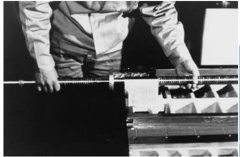
사진 14.4 볼스크류 너트의 설치
