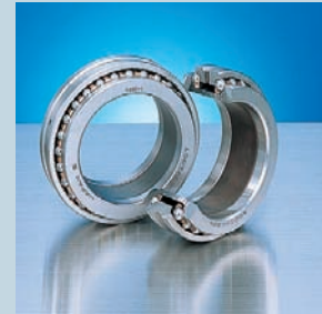
복식 슬러스트 앵글러 볼 베어링 TAC시리즈 접촉각60°을 채용한 고강성 복식 슬러스트 앵글러 볼 베어링 액시얼 강성이 향상됨.
